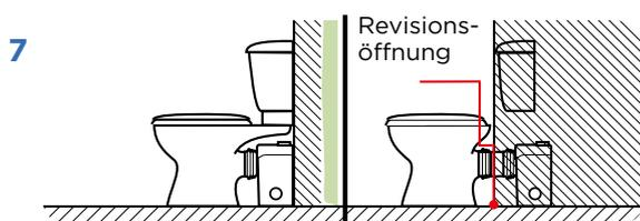
7 Das Gerät muss hinter der Toilette installiert werden und leicht zugänglich sein. Bei einer Installation in einer Vorbauwand ist eine Revisionsöffnung (mind. 50x50 cm) vorzusehen.
