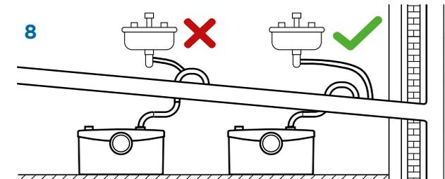
8 Sanitärgegenstände dürfen nicht an die Druckleitung der Hebeanlage angeschlossen werden.
