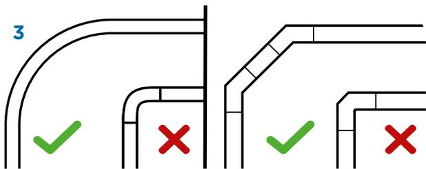
3 Durch größere Krümmungsradien werden Druckverluste in der Abflussleitung verringert. Wenn Sie Winkelstücke anbringen möchten, verwenden Sie 2 Teile mit 45°-Winkeln anstelle von einem Teil mit 90°-Winkel.
