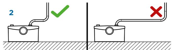
2 Wenn eine vertikale Druckleitung erforderlich ist, muss diese bereits im vorderen Teil vertikal nach oben geführt werden (max. 30 cm vom Gerät entfernt). Zusätzlich ist die Installation eines Absperrventils für Wartungsarbeiten notwendig.
