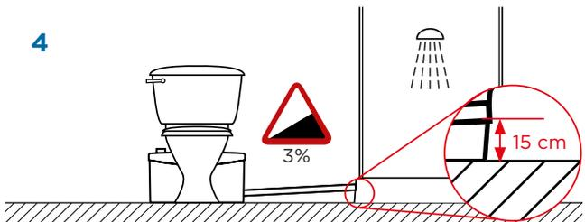
4 Sorgen Sie für ein Gefälle zwischen den Sanitäranlagen und der Hebeanlage (optimal sind 3%). Von Unterkante Gerät bis Unterkante Duschwanne mind. 15 cm Höhendifferenz (bei max. 1 m Abstand) einhalten. Je Zusatzmeter 1 cm Höhendifferenz zugeben.
