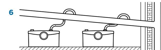
6 Jede Abwasserleitung der Hebeanlage muss separat und von oben an das Fallrohr angeschlossen werden und in Abflussrichtung verlaufen.
