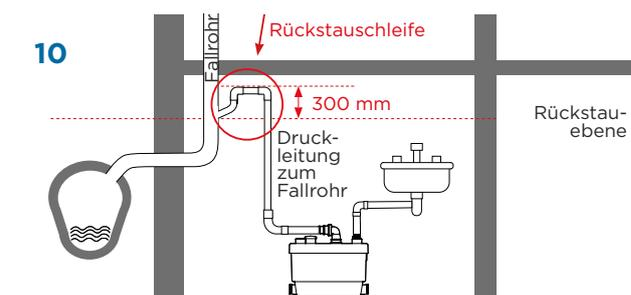
10 Beim Einsatz unterhalb der Rückstau-ebene ist zur Absicherung eine Rückstauschleife in die Druckleitung einzubauen.
