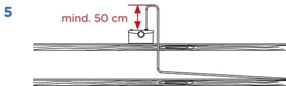
5 Bei direktem Abfluss nach unten muss zuvor eine mind. 50 cm senkrecht nach oben ausgeführte Druckschleife eingebaut werden.
